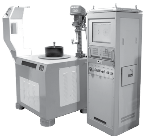
Fig 30. Foto balanceadora vertical de INTERMEC
